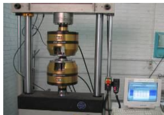
شکل ۱۸: یک دستگاه INSTRON ۸۸۰۲ در حال بارگذاری روی یک نیمکره به وسیله صفحه صلب.
